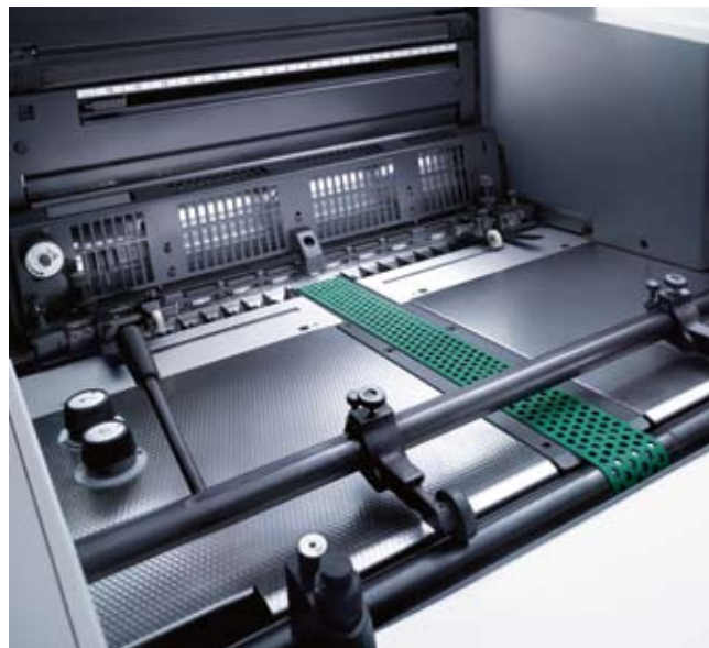
El marcador con cinta de aspiración central proporciona un transporte de los pliegos sin marcas.
