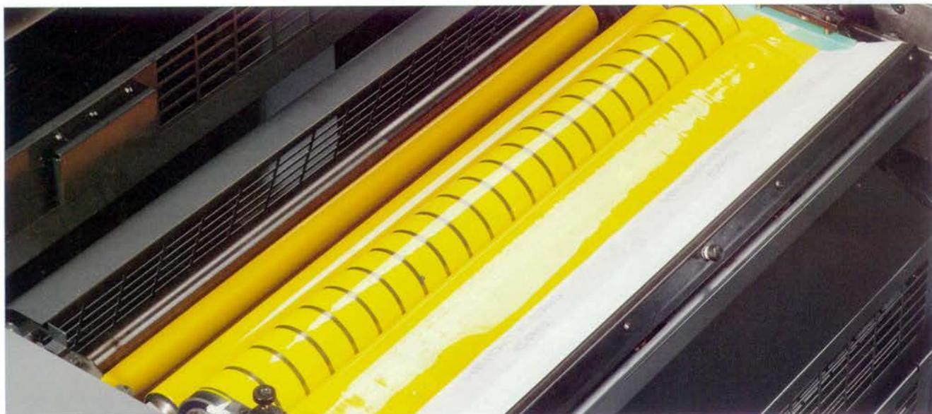
*En la puesta a punto, los tinteros CPC posibilitan un preajuste del entintado mandado por ordenador. Durante el tiraje, el entintado se mantiene estable y reproducible.*
