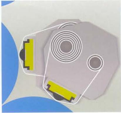
*Con estas marcas, el Autoregister CPC 42 controla el registro de la máquina para la corrección automática en la puesta a punto y durante el tiraje.*
