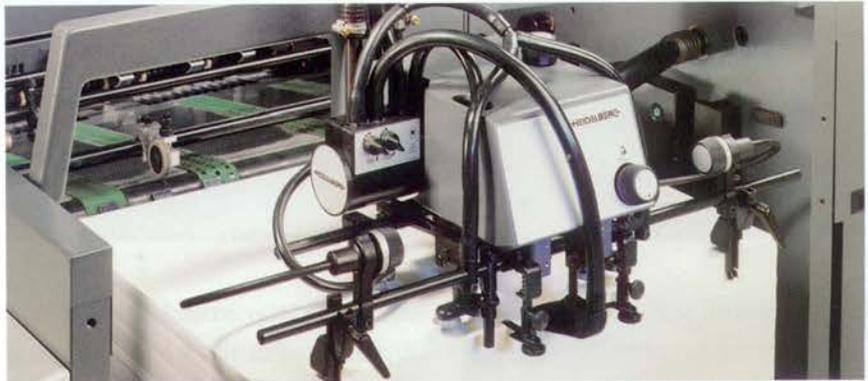
La regulación automática de la llegada del pliego reconoce a tiempo los pliegos que llegan a las guías delanteras demasiado pronto, demasiado tarde o torcidos. CPTronic calcula la diferencia respecto al momento óptimo y corrige automáticamente la escalerilla de pliegos. Según requerimientos, el marcador puede equiparse con un carro de pila o con plancha portapilas que permite elaborar directamente el papel desde la paleta.
