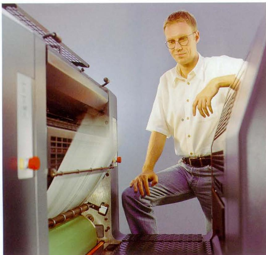
*El Autoplate va incluido de serie en el paquete de automatización de las Speedmaster SM 74 y posibilita el cambio de planchas sin herramientas, con gran exactitud de sujeción.*
