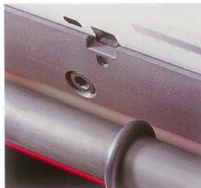
*Los pernos de registro aseguran el posicionamiento exacto de la plancha sobre el cilindro.*
