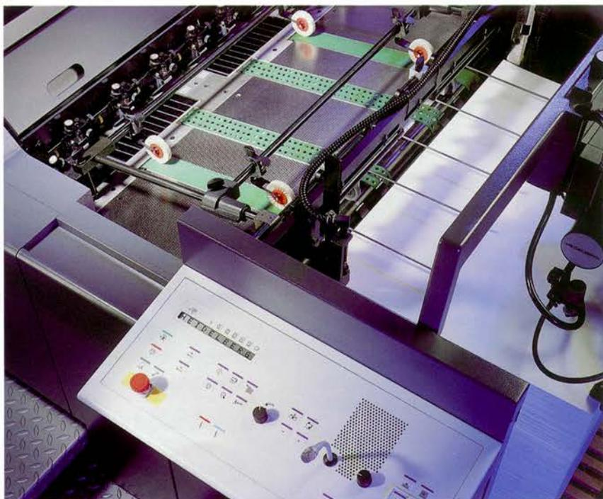
*Cintas de aspiración transportan suavemente los pliegos a las guías delanteras. El teclado sensitivo permite mandar las funciones de la máquina desde el marcador.*
