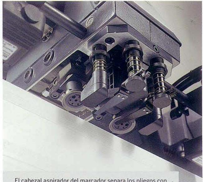
El cabezal aspirador del marcador separa los pliegos con aspiradores de elevación y de arrastre combinados de forma fiable, incluso a 15.000 pliegos por hora.
