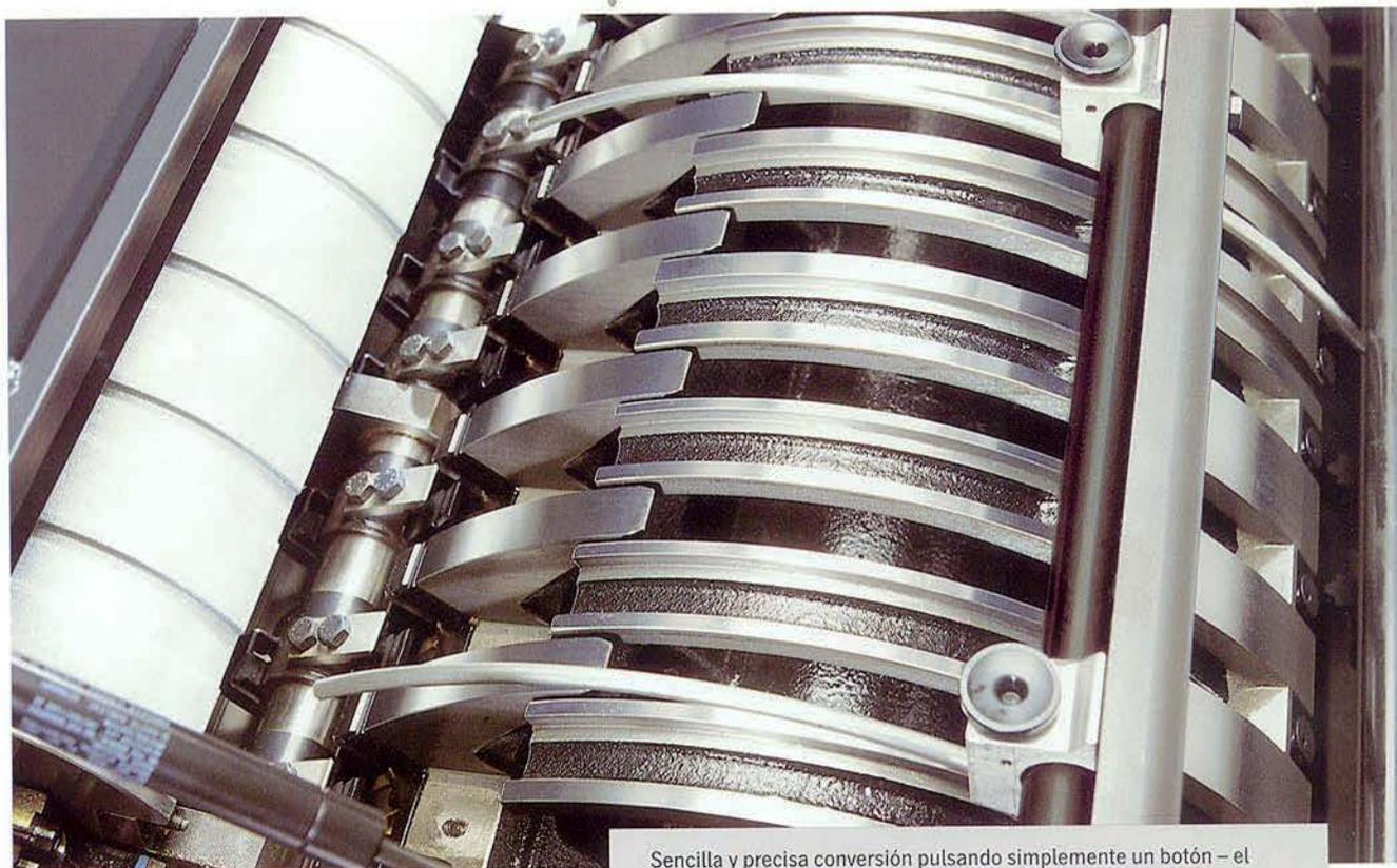
Sencilla y precisa conversión pulsando simplemente un botón – el tambor almacén y las levas de pinzas se colocan en la posición precisa mediante mando neumático.
