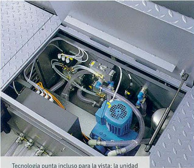
Tecnología punta incluso para la vista: la unidad compacta de alimentación de barniz ha sido integrada de un modo accesible en la máquina.
