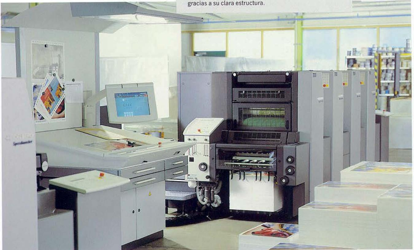
La tecnología punta no tiene por qué ser complicada. Con el CP2000 Center, manejar la máquina resulta sorprendentemente fácil. El claro diseño de la superficie de usuario informa continuamente al impresor sobre el estado de la máquina y la evolución de los procesos. El control centralizado de las funciones más importantes –p.ej., el color y el registro, el dispositivo de lavado y la conversión del dispositivo automático de inversión– se efectúan en la pantalla inclinable Touch Screen.
