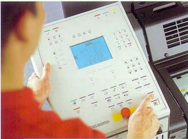
En la salida de las máquinas Un y Dos Colores se pueden realizar, a través de CPTronic, ajustes para el registro diagonal, lateral y circunferencial.
