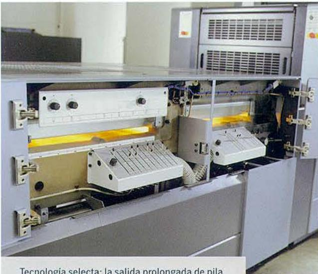
Tecnología selecta: la salida prolongada de pila alta con secador DryStar 2000 Combination integrado.
